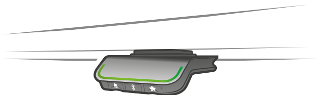
Obrázek 4 : Zeleně pulzující světelný pruh indikuje "vše je OK"
